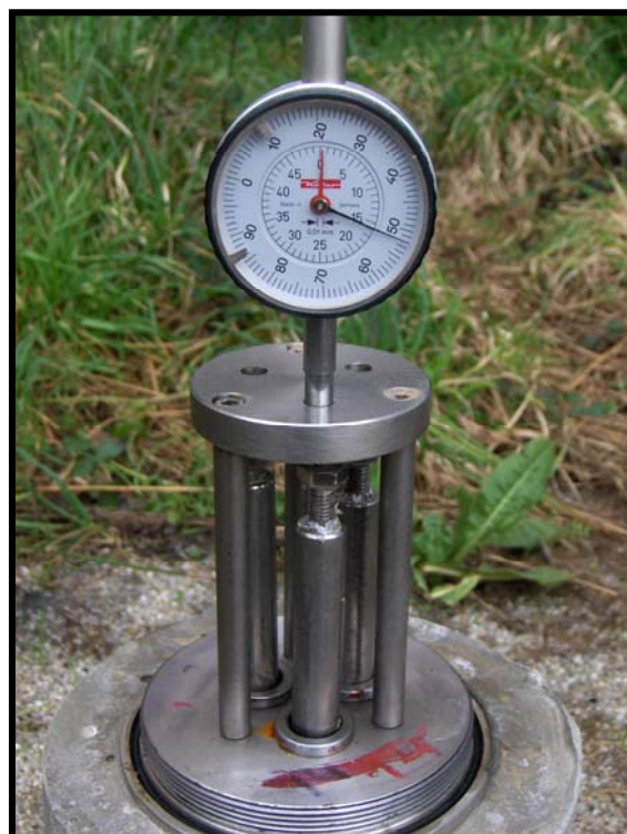
Cabezal para medida con comparador
