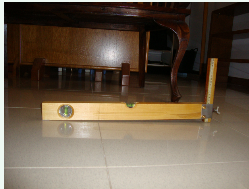
“Santy Fotógrafo”: medición de pendiente del pavimento.
