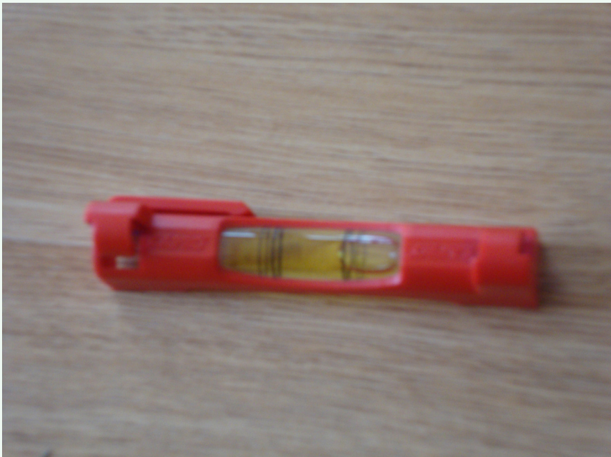
Oficinas de Reale Seguros: nivel de burbuja donde se aprecia la fuerte pendiente del pavimento
