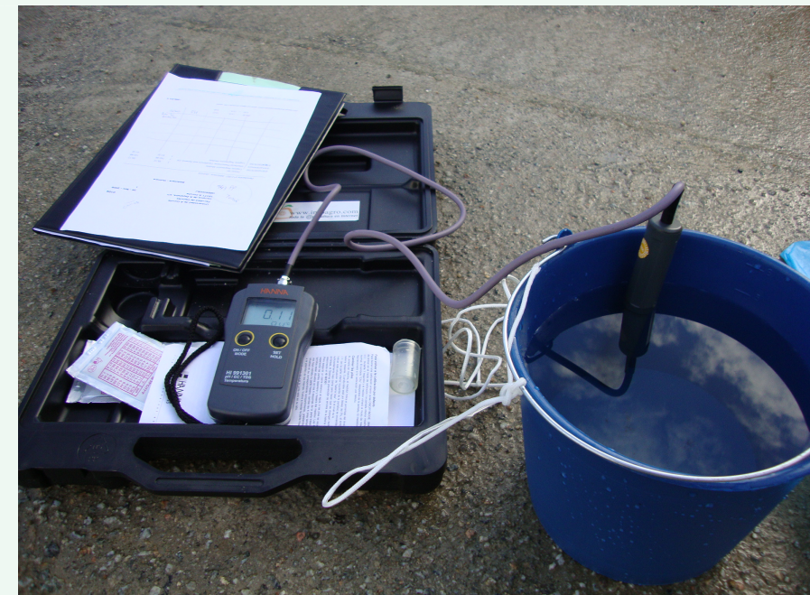
Instrumento de campo utilizado para analizar la calidad de agua de los ríos Pelamio y Rego de los Prados, y de la marisma.
