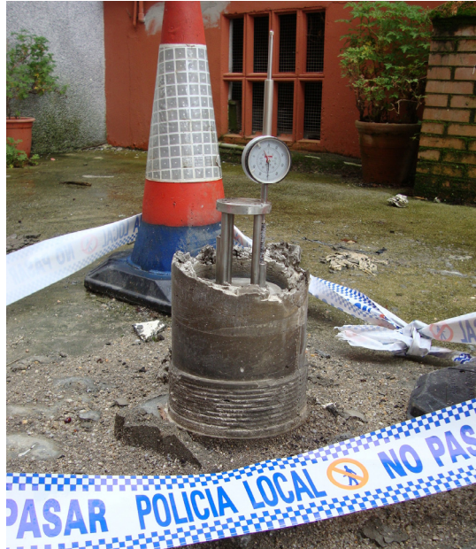
Vista del instrumental interno del extensómetro E-1 emplazado en el S-5, detrás de "Santy fotógrafo".
