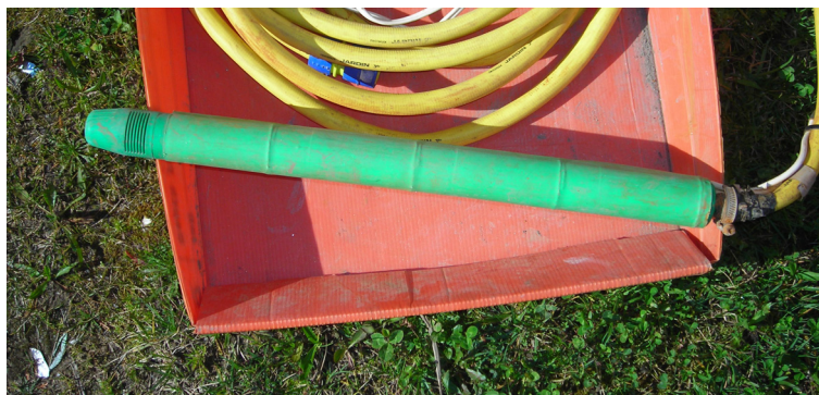
Detalle de la bomba tipo “lápiz” utilizada en los ensayos
