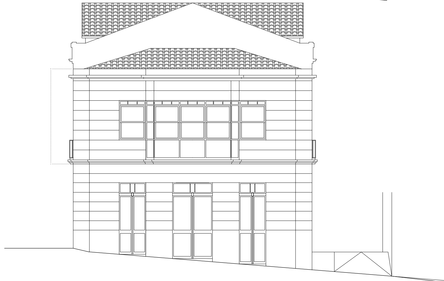
ALZADO OESTE ESTADO REFORMADO
